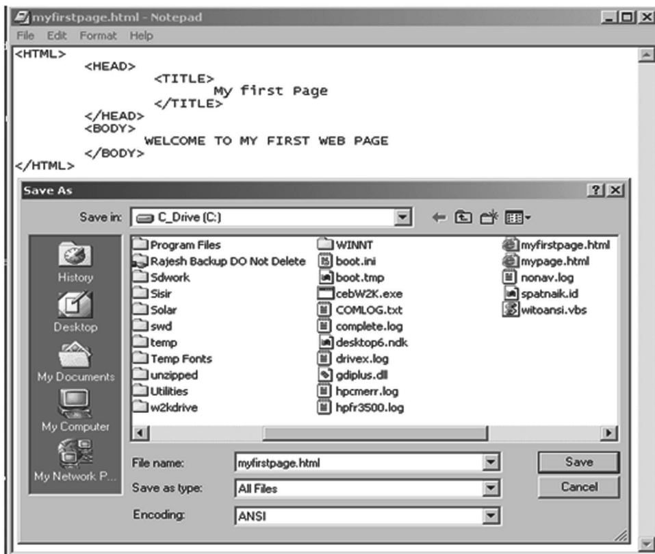
चित्र 2.1: नोटपैड का उपयोग करते हुए HTML डॉक्यूमेंट को बनाना और संरक्षित (सेव) करना
